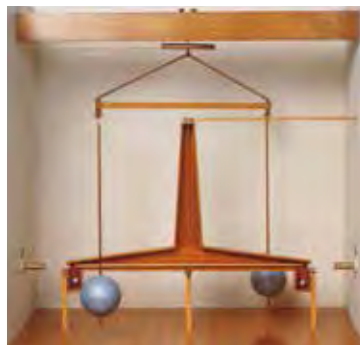
图 4-10 卡文迪许实验装置模型
