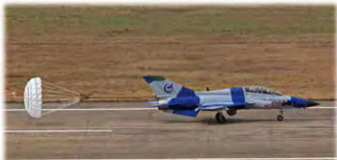
图 1-4 飞机着陆后打开尾部减速伞
