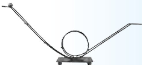
图 3-25 “过山车”实验装置
