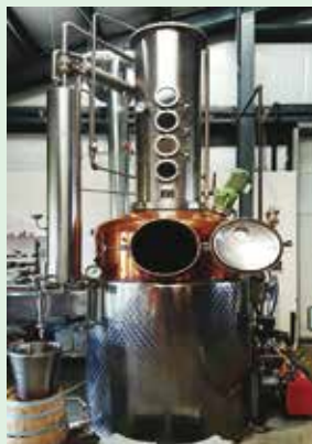
图3-4-5 现代酒厂中常用的蒸馏设备
