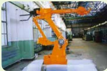
图9-1-14 点焊机器人
