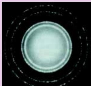
图 1-1-10 铝箔的电子衍射图样
