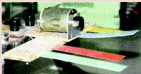
图1-32 用共振现象测量机器的振动频率
