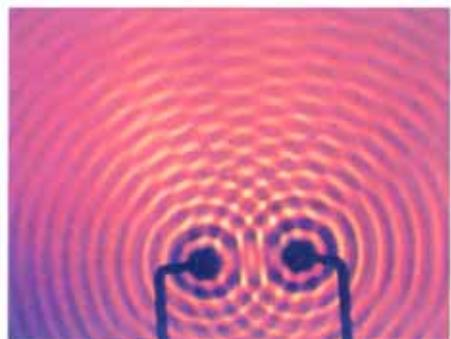
图2-34 水波的干涉图样
