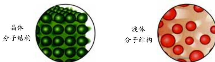
图1-28 晶体熔化成液体的过程中,分子之间的距离增大
