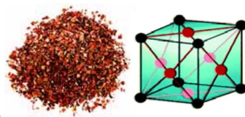
图2-22 铜晶体及其结构模型
