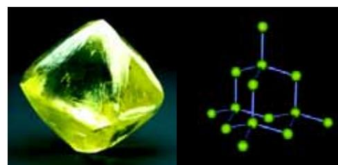
图2-26 金刚石及其晶体结构
