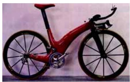
图2-36 用碳纤维制成的自行车
