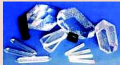
图2-16 人造水晶（一种常用的压电晶体）
